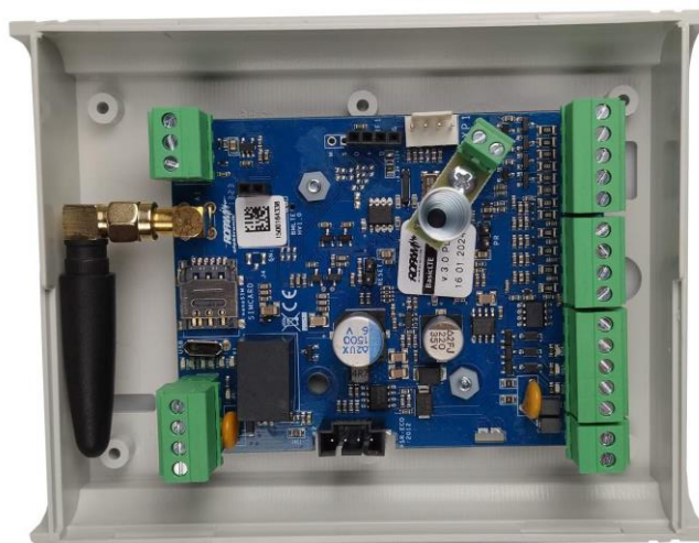
1 BasicLTE-BOX moduł w obudowie natynkowej z tamperem.
